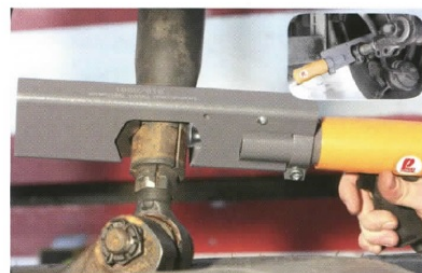
Pneumatický přípravek pro povolování tyčí typ bat-truck. (foto: MAHA Consulting s. r. o.)
